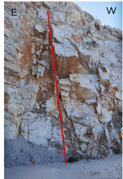
Figure 7 : exemple des discontinuités de type F1 sur le front 3
